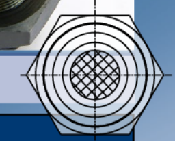
Auflagefläche mit Hartmetall-Einsatz (HM)
